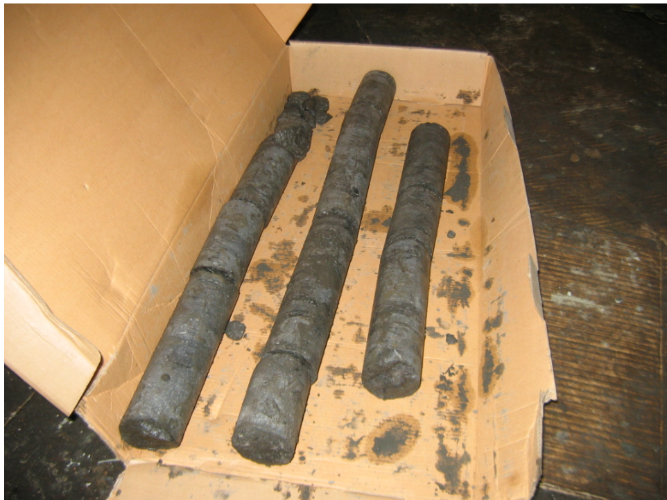
Photo 18 : Échantillonnage du Roc dans le forage 1
